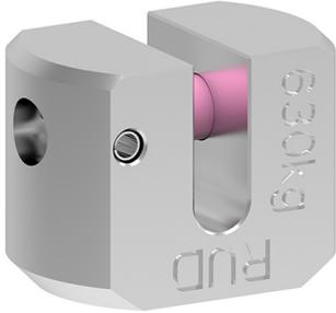
Zur Sicherung des Kettenstranges bei Anwendung des VIP-Mini-Lifters als Einstrang-Verkürzung. Wir empfehlen den VIP-Mini-Lifter grundsätzlich mit 2 Stück VIP-Mini-Haken auszurüsten, dann ist ein universeller Einsatz möglich und die Kette kann nicht versehentlich durch den MiniLifter gezogen werden.
