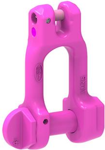
Hochfeste Ausführung mit integriertem Sicherungsgewinde im Schäkelbügel. Beidseitig glatte Bolzenauflage im Schäkel. Bolzen drehbar. Keine Biegespannung im Gewinde, sondern nur Sicherungsfunktion. Optimale Abstimmung - max. Maulweite bei kleinsten Schäkelbolzen. Langzeitsicherung durch Einschlagen der vormontierten Spannhülse. Sondergewinde, dadurch verwechslungsfrei gegenüber anderen Schäkelbolzen. Komplett mit Verbindungsbolzen und Spannhülsen vormontiert.
