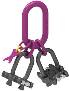
Aufhängeeinheit mit integrierter Verkürzungsmöglichkeit für alle 4 Kettenstränge, speziell für 4mm-ICE-Anschlagkette. Durch Drücken der Arretierbolzen wird das Kettenkreuz entriegelt, Kette kann dann eingefädelt bzw. in der Länge verstellt werden. Ideal für Kleinlasten bis 1700 kg (bei 4-Strang-Anwendung).
