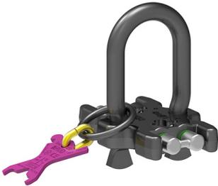
Aufhängekopf mit integrierter Verkürzungsmöglichkeit, speziell für 4mm-ICE-Anschlagkette. Auch als 1-Strang verwendbar (ICE-Endanschlag 7905039 als Endbeschlag in Kette montieren). Durch Drücken der Arretierbolzen wird das Kettenkreuz entriegelt, Kette kann dann eingefädelt bzw. in der Länge verstellt werden. Ideal für Kleinlasten bis 1120 kg (bei 2-Strang-Anwendung).
