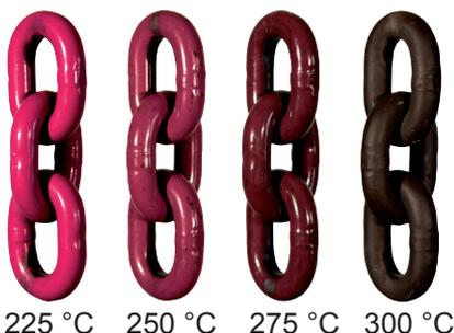
Abb. 8: ICE-Überhitzungsanzeige bei pinkbeschichteten Ketten
