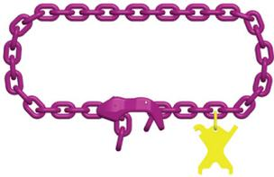
Ein häufiges Problem beim Direktverzurren der Ladung ist, dass an der Ladung keine Zurrpunkte vorhanden sind, oder die Anschlussmaße der vorhandenen "Zurrpunkte" (häufig nur Ausbrennlöcher oder Bohrungen) es nicht zulassen, den Zurrhaken eines Zurrmittels ordnungsgemäß anzubringen.
