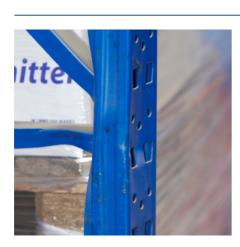
Selbst geringfügig erscheinende Schäden durch Stoßeinwirkung an einem Teil der Konstruktion, speziell die Beschädigung von Stützen und Trägern, können die Statik eines Regalsegmentes oder des gesamten Regals negativ beeinflussen.
