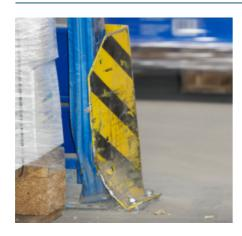
Oftmals wird Rammschutz an den sensiblen äußeren Regalstützen präventiv eingesetzt. Starre Stahlwinkel sind jedoch nur ein wenig wirksamer Anfahrschutz.
