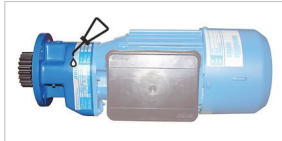
Schmierung ab Werk durch Schmierstoff mit der Normbezeichnung: GP 00 K-45 (DIN 51502)
