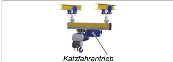
Der Fahrantrieb HBF besteht aus einem Fahrmotor mit Reibrad, das unterhalb der HB-Profilschiene fährt und einem Fahrwerk HBF, das in der HB-Profilschiene fährt und mit dem Fahrantrieb HBF verbunden ist. Die Einheit aus Fahrantrieb HBF und Fahrwerk HBF wird mit einer Kupplungsstange mit dem HB-Kran oder mit der Katze verbunden.
