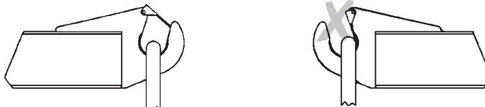
No utilice el chasis para elevar otros dispositivos o para amarrar cargas a través de cables, eslingas o cadenas.
