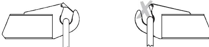
Ne pas utiliser le chassis de base pour soulever d'autres appareils de levage ou pour attacher les charges avec des câbles, sangles ou chaînes.
