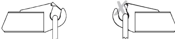
Der Grundkörper darf nicht zum Anheben von weiteren Lastaufnahmemitteln oder zum Anschlagen von Lasten mittels Seilen, Bändern oder Ketten benutzt werden.
