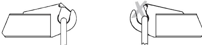
Nooit de behuizing gebruiken voor het optillen van andere hijshulpmiddelen of om er andere lasten aan vast te maken met kabels, stroppen of kettingen.
