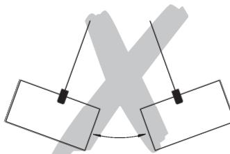
Il est interdit de transporter des piles de tôles soumises à une forte déflexion lors du transport car la charge risquerait de glisser hors de la pince.
