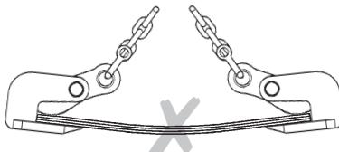
Il est interdit de soumettre l'appareil de levage à une force de traction latérale avec un angle d'inclinaison de plus de 15°.
