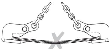
Die Belastung des Lastaufnahmemittels mit seitlichen Zugkräften bei einem Neigungswinkel größer 15° ist verboten.
