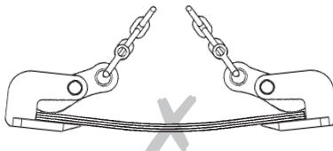
Запрещается приложение боковых тяговых усилий на грузозахват при угле отклонения более 15°.
