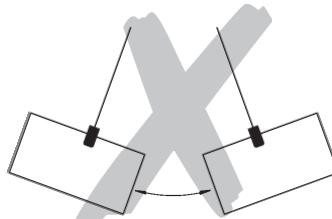
Der Transport von Blechpaketen, die beim Transport eine wesentliche Durchbiegung erfahren, ist verboten, weil die Last aus der Klemme herausrutschen kann.
