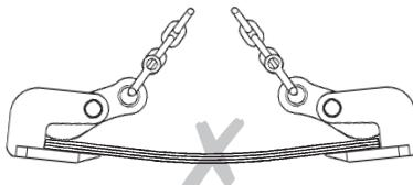
Está prohibido aplicar fuerzas laterales con un ángulo de inclinación de más de 15° al dispositivo de elevación.
