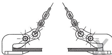
Ne pas utiliser le chassis de base pour soulever d'autres appareils de levage ou pour attacher les charges avec des câbles, sangles ou chaînes.
