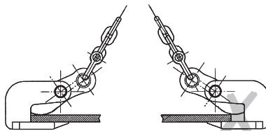
Основные элементы устройства запрещается использовать для подъема прочих грузозахватов или строповки грузов с помощью тросов, ремней или цепей.
