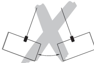
Está prohibido transportar paquetes de planchas que estén sujetas a una deformación grande durante el transporte, ya que en este caso la carga puede salirse de la garra.
