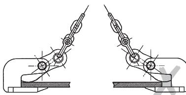
Az alaptest nem használható további teherfelvevő eszközzel történő emeléshez vagy a teher kötéssel, hevederrel vagy láncjal történő rögzítéséhez.
