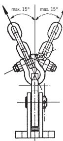
Das Hebegut muss immer bis zum Anschlag aufgeschoben werden.
