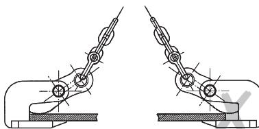
Der Grundkörper darf nicht zum Anheben von weiteren Lastaufnahmemitteln oder zum Anschlagen von Lasten mittels Seilen, Bändern oder Ketten benutzt werden.
