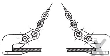
Nepoužívajte základný rám pre zdvívania ďalších zdvíhacích zariadení, ani ku nim nepripravujte bremena pomocou lán, pásov, alebo reťazí.
