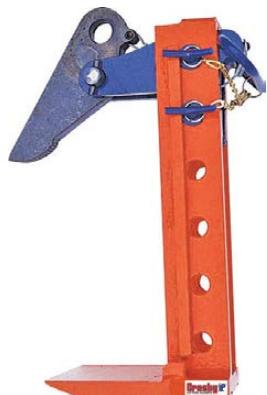
Modell IPPE eignet sich für das Heben und Transportieren formstabiler Stahlplattenstapel in waagerechter Position. Die Maulweite ist problemlos einstellbar. Durch Anheben des Hebels wird das Maul geöffnet. Dies ermöglicht das einfache und schnelle Anbringen und Lösen der Klemme.
