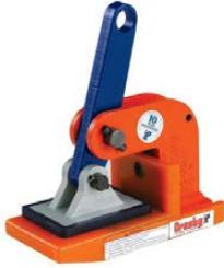
Die horizontalen Hebeklemmen IPHNM10 verfügen über ein Vorspannsystem, mit dessen Hilfe sich die Klemmen zum horizontalen Transportieren und Heben an formstabilem Material befestigen lassen. Zu verwenden, wenn die Oberfläche des Materials nicht beschädigt werden darf. Diese Klemmen müssen mindestens paarweise eingesetzt werden.
