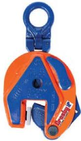
Die vertikale Hebeklemme IPU10 eignet sich zum Heben, Wenden, Bewegen oder zum vertikalen Transportieren von Blechen, Platten und Konstruktionen sowie zum Kippen aus horizontaler in vertikale Lage (180°) und umgekehrt. Dank der Gelenkhülse kann die Klemme die Last aus jeder Richtung absetzen und anheben, mit einem mehrsträngigen Stropp auch ohne seitliche Belastung der Klemme.
