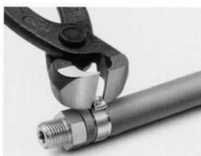
... zur Klemmen-Demontage die Zange quer am Ohr ansetzen und Ohr aufschneiden...
