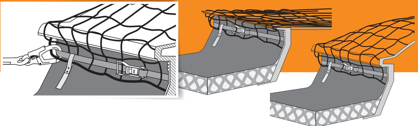
Die mobile Lichtkuppeldurchsturz­sicherung MOBI von INNOTECH aus hochfestem Polypropylen wird als Durchsturz­sicherung ebenso angewendet wie als Einzelanschlagpunkt für eine Person.
