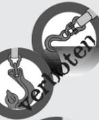
■ Quersteife, z.B. beschichtete Hebebänder mit Schlaufen dürfen beim Heben nicht geschnürt werden.
