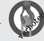
■ Anschlagmittel dürfen nicht über scharfe Kanten gespannt und nicht über scharfe Kanten gezogen werden, da das Anschlagmittel durchtrennt wird. Eine scharfe Kante liegt bereits vor, wenn der Kantenradius „r“ gleich/ kleiner als die Dicke/Durchmesser „d“ des Anschlagmittels ist. **Bei scharfen Kanten unbedingt Kantenschutz verwenden!**
