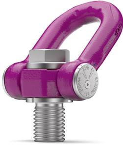
Der RUD ACP-TURNADO SUPERMAX setzt neue Maßstäbe für das sichere Heben wertvoller Lasten. Sein Bügel dreht sich dank einer innovativen innenliegenden Federmechanik beim Anheben der Last sofort in Krafrichtung, kann also nicht senkrecht stehenbleiben. Gefährliche Querbelastungen und ein ruckartiges Absacken der Last durch das plötzliche Ausdrehen in Krafrichtung sind damit ausgeschlossen.
