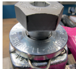
Abb. 14: Sprengring umlaufend vertieft in der Ansenkung positioniert
