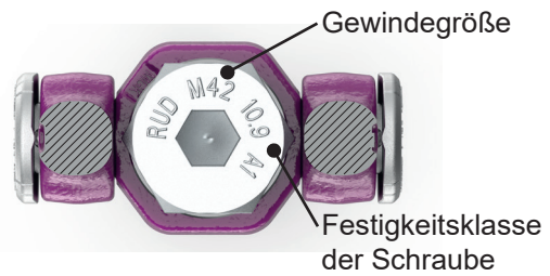
Abb. 2: ACP M36-M48 bzw. 1 1/2"-2" - Kennzeichnung Schraube
