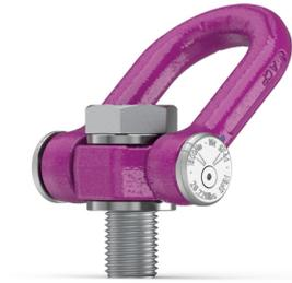
Der RUD ACP-TURNADO MAX setzt neue Maßstäbe für das sichere Heben wertvoller Lasten. Sein Bügel dreht sich dank einer innovativen innenliegenden Federmechanik beim Anheben der Last sofort in Krafrichtung, kann also nicht senkrecht stehenbleiben. Gefährliche Querbelastungen und ein ruckartiges Absacken der Last durch das plötzliche Ausdrehen in Krafrichtung sind damit ausgeschlossen.
