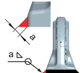
Abb. 5: Schweißnahtanordnung
