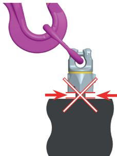
Abb. 3: So-PP muss vollständig eingeschrraubt sein
