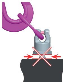
Abb. 3: PP muss vollständig eingeschraubt sein
