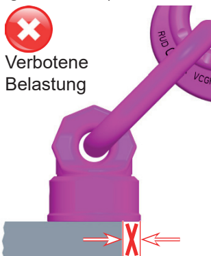
Abb. 3: VWBG muss vollflächig aufliegen (Auflage \geq D )
