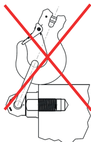
Abb. 2: Verbotene An- bzw. Auflage an Kanten
