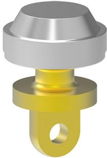
Zum Einbau in Demag-PK 1000-Hebezeuge. Komplett mit Original-Demag-Kugellager. Aus hochfest vergütetem Sonderstahl. Geprüft in Anlehnung an DIN EN 1677-1 und DGUV Regel 109-017. Passend für Einstrang-Hakenflaschen und Zweistrang-Unterflaschen. Passend für alle VIP-8mm-Gabelkopf-Bauteile.
