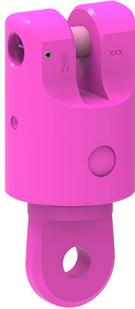
Kugelgelagert, dadurch auch unter Last drehbar. Vielseitig kombinierbar, durch Adaptersteg mit allen VIP-Bauteilen am Gabelkopf verwechslungsfrei montierbar. Schmutzunempfindlich durch Abdichtung. Komplett mit Verbindungsbolzen und Spannhülse vormontiert. Die BGR 500/DGUV-Regel 100-500 schreibt vor: Anschlagmittel müssen vor der Verwendung ausgedreht werden. Mit dem VWA wird dies automatisch erledigt.
