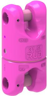
Kugelgelagert, dadurch auch unter Last drehbar. Komplett mit Verbindungsbolzen und Spannhülse vormontiert. Die BGR 500/DGUV-Regel 100-500 schreibt vor: Anschlagmittel müssen vor der Verwendung ausgedreht werden. Mit dem VUW wird dies automatisch erledigt.
