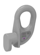
passend für ISO-Containerecke. Festanschluß mittels Verbindungsschloß bzw. loses Bauteil für Hakeneinhängung. Achtung: RUD-VCH-Haken sind nicht zum senkrechten Anheben geeignet. Neigungswinkel min. 30°, dann selbsttätiges Lösen während des Hebevorgangs nicht möglich. Bei 1D, 1E, 1F-Container kann mit 4-Strang, max. Neigungswinkel 30° an oberer Containerecke angehoben werden.
