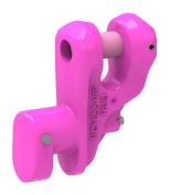
passend für ISO-Containerecke. Mit patentierter Sicherheitsverriegelung. Gabelkopfanschluß für 22er-VIP-Kette. Durch Anschluß einer Ringgabel VRG-16 kann auf 16er-VIP-Kette reduziert werden. Achtung: RUD-VCH 22-Haken sind nicht zum senkrechten Anheben geeignet. Neigungswinkel min. 30°, dann selbsttätiges Lösen während des Hebevorgangs nicht möglich. Komplett mit Verbindungsbolzen und Spannhülsen vormontiert.
