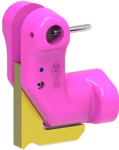
Für den Einsatz bei 0-40°. Passend für ISO-Containerecke. Mit Sicherheitsverriegelung. Gabelkopfanschluß für 16er-VIP-Kette. Komplett mit Verbindungsbolzen und Spannhülsen vormontiert.
