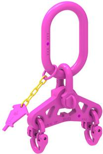
VIP-Wippenkopf für Gehänge mit VIP-Wippen. Beim Einsatz von zwei 2-Strang-Gehängen, wobei ein Gehänge mit einer Wippe (VWK-2S) versehen ist, beide im Kranhaken eingehängt, kann bei symmetrischer Lastverteilung mit 4 tragenden Kettensträngen gerechnet werden (BGR 500/DGUV-Regel 100-500). Dadurch erhöhte Tragfähigkeit. **Achtung: dies gilt nur bis max. 45° Neigungswinkel.**
