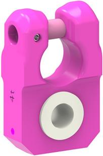
VIP-Gabelkopf-Isolierlasche bis max. 1000 V isoliert. Zum Schweißen von am Kran hängender Last, die Gefahr des Stromdurchflusses in die Krananlage wird minimiert. Max. Betriebstemperatur +80°C.
