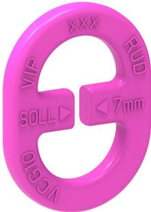
Die Vorderseite des VCG mit der Beschriftung - Soll ...mm - muss frei bleiben. Bei der Montage VCG-Kontrollglied zuerst in den Bügelbolzen des VIP-Verbindungsschlusses VVS einhängen, danach 3-Gld.-Kettenstück VIP. Nur Original-RUD-VIP Bauteile verwenden! **Nur mit Bypass montieren:**
