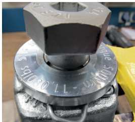
Abb. 12: Sprengring umlaufend vertieft in der Ansenkung positioniert
