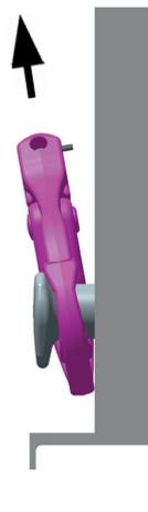
Abb. 7: Ausrichtung des Hakens bei Schrägzug
