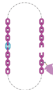
Abb. 21: Kranzkettenmontage mit Dominator
