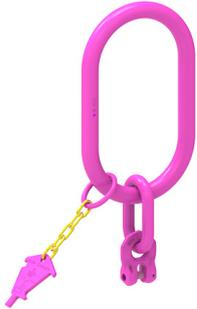
VSAK 1-Strang mit eingeschweißter, allseitig beweglicher Ringgabel - VRG -, dadurch Zwangsanschluß für Ø-Kette und Strangzahl. Der VIP-Aufhängekopf ist mit dem RUD-ID-TAG® (RFID-Chip) ausgestattet und kann über die eindeutige Identifikationsnummer zugeordnet werden. Kompletter Kennzeichnungsanhänger mit integrierter Kettenprüflehre. Verbindungsbolzen und Sicherungsstift sind vormontiert. Gefertigt entspr. DIN EN 1677-4.
