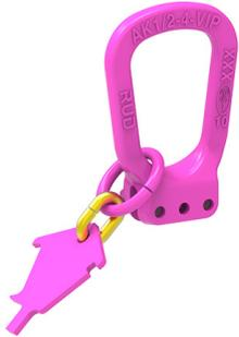
Geschmiedeter Aufhängekopf speziell für 4mm-VIP-Anschlagkette. Der VIP-Mini-Aufhängekopf ist mit dem RUD-ID-TAG® (RFID-Chip) ausgestattet und kann über die eindeutige Identifikationsnummer zugeordnet werden. Gefertigt entspr. DIN EN 1677-4. Für 1-Strang mittigen Anschluß verwenden. Auch als Endglied verwendbar (Kennzeichnungsanhänger entfernen).
