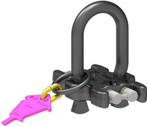
Aufhängekopf mit integrierter Verkürzungsmöglichkeit, speziell für 4mm-VIP-Anschlagkette. Auch als 1-Strang verwendbar (VIP-Endanschlag 7990215 als Endbeschlag in Kette montieren). Durch Drücken der Arretierbolzen wird das Kettenkreuz entriegelt, Kette kann dann eingefädelt bzw. in der Länge verstellt werden. Ideal für Kleinlasten bis 880 kg (bei 2-Strang-Anwendung).
