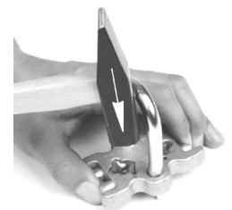
Haltebolzen eindrücken und neue Spannhülse einschlagen
