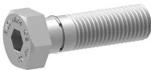
Sechskantschraube ist mit einem Sprengring versehen, damit sie unverlierbar in einen VLBG-PLUS montiert werden kann. Bei Verwendung mit VLBG-PLUS ergibt sich eine freie Einschraublänge  $H=30\text{mm}$
