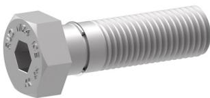
Sechskantschraube ist mit einem Sprengring versehen, damit sie unverlierbar in einen VLBG-PLUS montiert werden kann. Bei Verwendung mit VLBG-PLUS ergibt sich eine freie Einschraublänge  $H=24\text{mm}$
