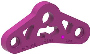
ICE-Wippen werden in 4-Strang-Gehänge (2x2-Strang eingebaut, um eine gleichmäßige Lastverteilung auf alle 4 Stränge zu erreichen. Hierbei werden Längentoleranzen in den einzelnen Kettenstränge durch Neigung der ICE-Wippe ausgeglichen.
