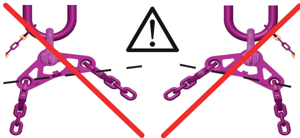
Abb 12: Schrägstellung der Wippe größer 10° ist nicht erlaubt!
