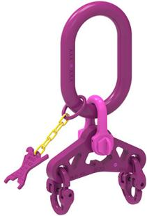
ICE-Wippenkopf für Gehänge mit ICE-Wippen. Beim Einsatz von zwei 2-Strang-Gehängen, wobei ein Gehänge mit einer Wippe (IWK-2S) versehen ist, beide im Kranhaken eingehängt, kann bei symmetrischer Lastverteilung mit bis zu 4 tragenden Kettensträngen gerechnet werden (BGR 500/DGUV Regel 100-500). Dadurch erhöhte Tragfähigkeit. Achtung: dies gilt nur bis max. 45° Neigungswinkel. Verwendbar bis Kranhaken Nr. 10 DIN 15401. Betriebsanleitung beachten !
