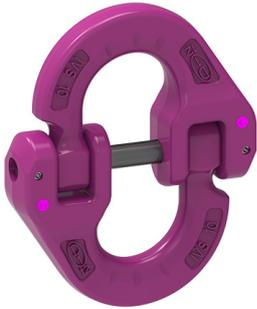
Das universell einsetzbare, zum Patent angemeldete ICE-Verbindungsschloß. Kein Verklanken der montierten Kette möglich. Der Verbindungsstift wird durch die bewährte Spannhülsen-Sicherung gehalten. Kein Wandern bzw. Beschädigen des Verbindungsstiftes. In die Schloßbügelhälften können Fremdanschlüsse z.B. Anschlagpunkte, Blechgreifer etc. sowie die Kette montiert werden.
