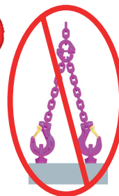
Abbildung 2: Falsche Montage und Anwendung Nur 1 tragender Strang zulässig.
