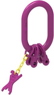
IAK-RG 2- Strang-Aufhängekopf für Standard-Kranhaken mit zwei eingeschweißten, allseitig beweglichen ICE-Ringgabeln, dadurch Zwangsanschluß für Ø-Kette und Strangzahl.
