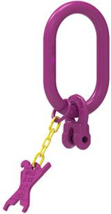
IAK-RG 1- Aufhängekopf für Standard-Kranhaken mit eingeschweißter, allseitig beweglicher ICE-Ringgabel, dadurch Zwangsanschluß für Ø-Kette und Strangzahl.
